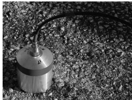
Ecoutes orbiphoniques d'ondes Très Basses Fréquences dans la structure de l'entrepôt Lainé.
